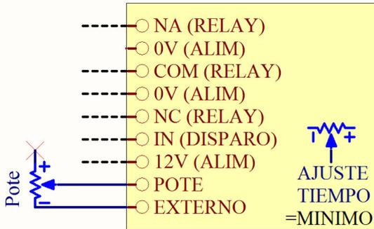
Es importante que el preset interior a la placa se ajuste al mínimo para que no sume resistencia al potenciómetro externo.
