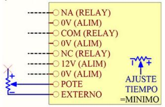
Es importante que el preset interior a la placa se ajuste al mínimo para que no sume resistencia al potenciómetro externo.
